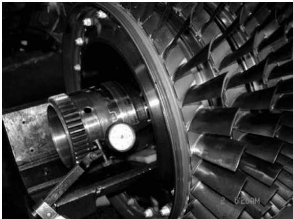
Рис. 6.9.9. Ротор КВД двигателя АИ222 на призмах: общий вид (а); замер биений ступиц (б), шестерни (в), торца вала переднего (г)
