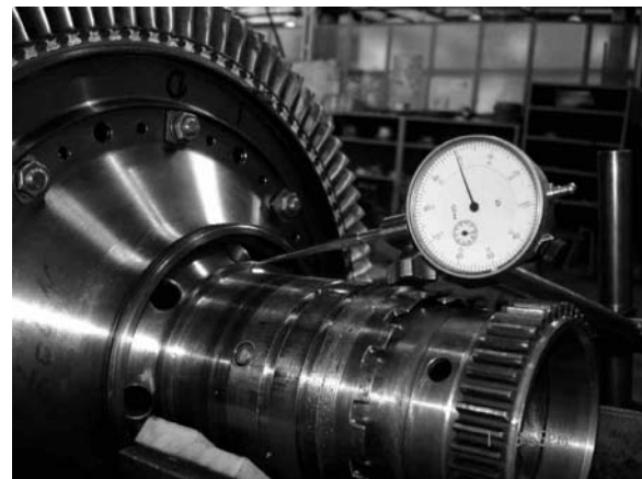
Рис. 6.9.9. Ротор КВД двигателя АИ222 на призмах: общий вид (а); замер биений ступиц (б), шестерни (в), торца вала переднего (г)
