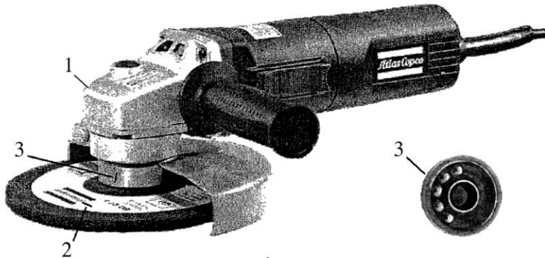
Рис. 1.18. Patent US 20020056338A1 - зрівноваження шліфувальних дисків ручних шліфувальних машин:
