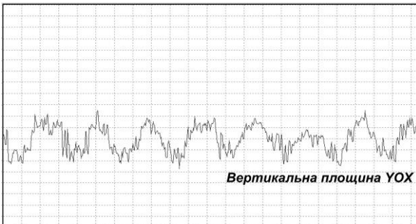
Рисунок 5.3 - Осцилограма вібрації КШМ з диском, АБ та дисбалансом
