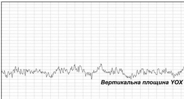
Рисунок 5.1 - Осцилограма вібрації КШМ без диска та затискного фланця
