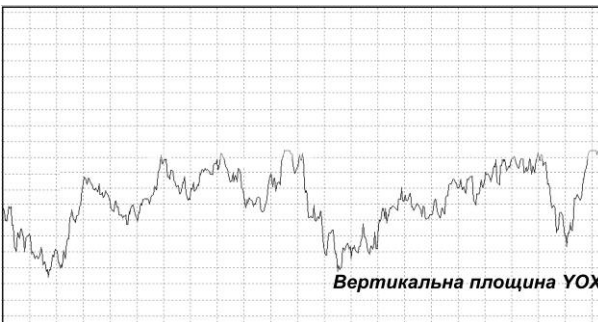
Рисунок 5.2 - Осцилограма вібрації КШМ з диском та дисбалансом
