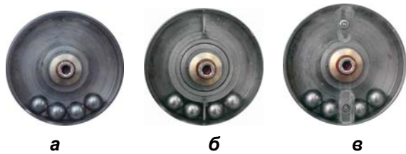
а - звичайний АБ; б - АБ з рухомими перегородками; в - АБ з нерухомими перегородками
