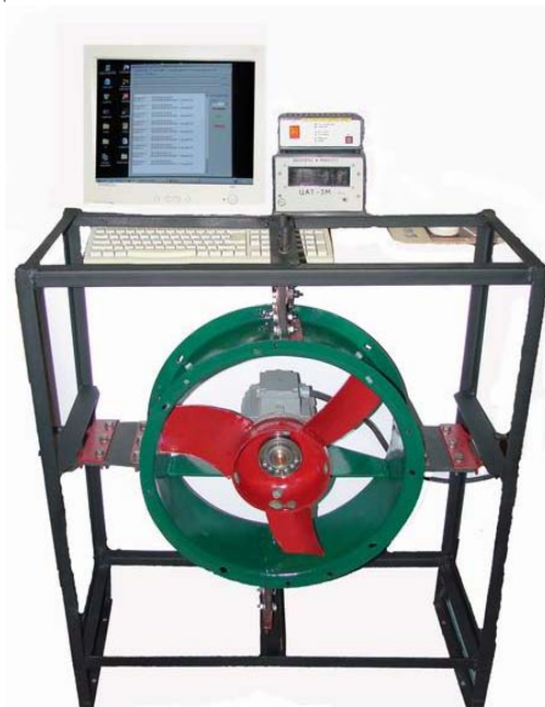
Рисунок 3 – Стенд для перевірки ефективності зрівноваження різними типами кульових автобалансирів крильчатки осьового вентилятора
